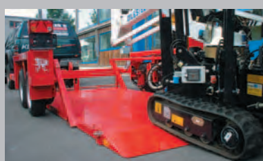
L'intera larghezza della piattaforma sostituisce la rampa, vale a dire che l'angolo di inclinazione ridotto consente di caricare anche veicoli con poca altezza libera dal suolo.
