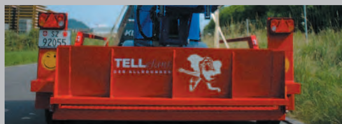
Rampa di chiusura modificata per fungere anche da protezione di guida inferiore
