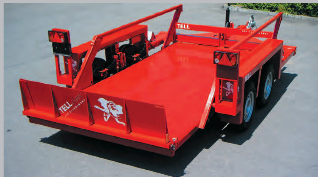
La batteria e i componenti idraulici sono integrati nel telaio e possono essere chiusi a chiave.
