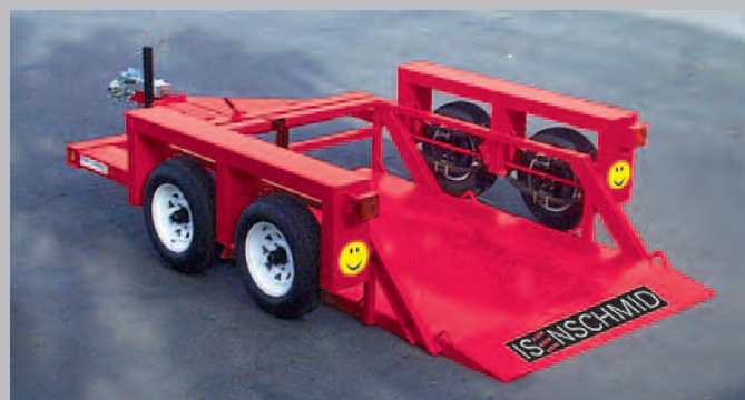
Rampa di chiusura modificata per fungere anche da protezione di guida inferiore
